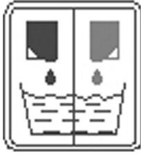
Die Anwahl des Reinigungsmittels kann mit der Taste „Reinigungsmittel“ (3/11) auch manuell erfolgen. Nach erfolgreicher durchgeführter Reinigung kehrt die Steuerung wieder in den vorprogrammierten Zyklus mit alkalischem oder saurem Reinigungsmittel zurück.
